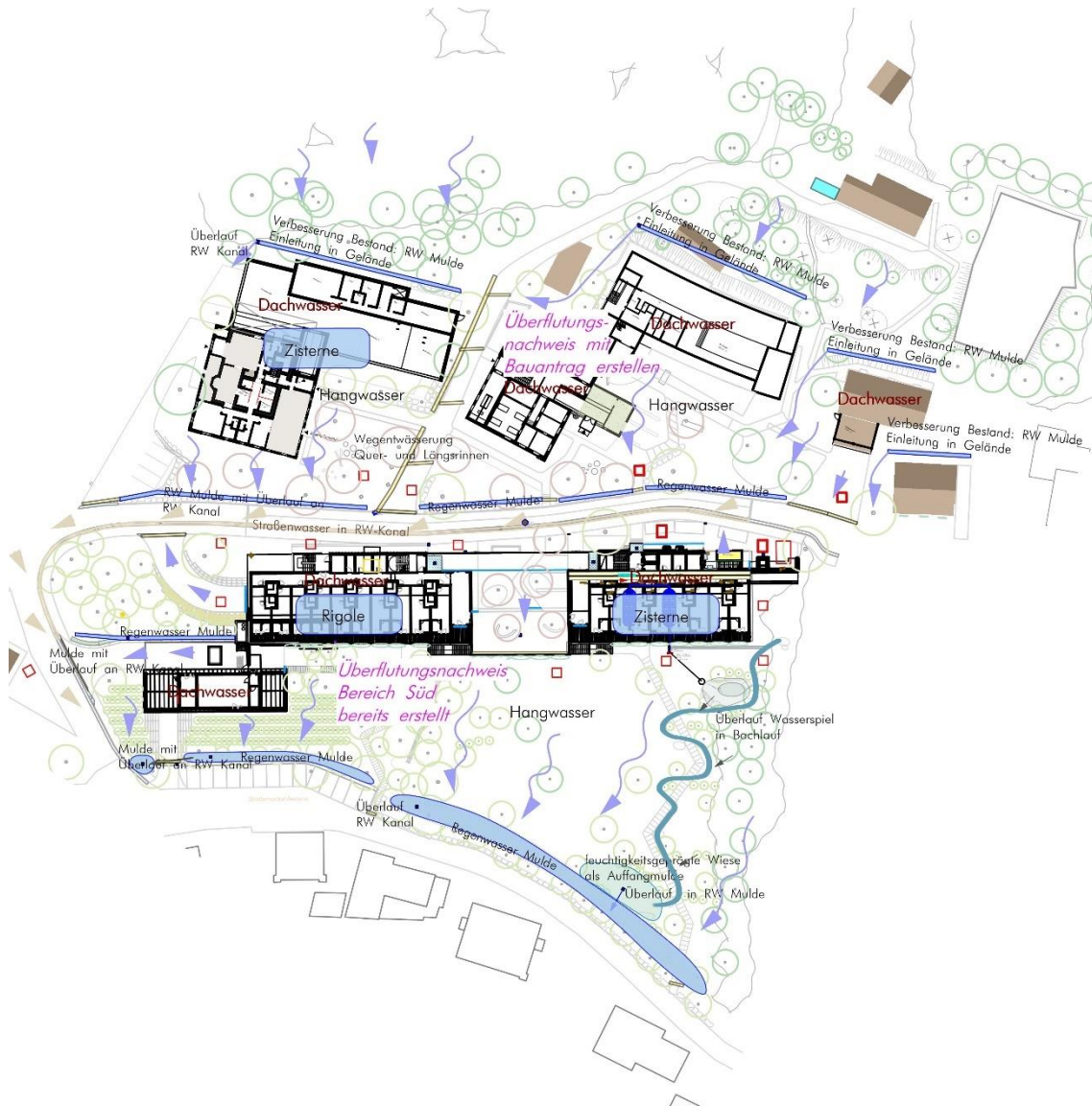
Abbildung 13: Umgang mit Regenwasser
